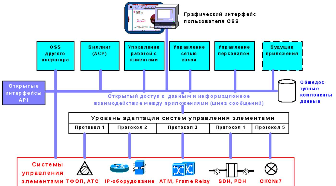
Рис. 2. Состав и структура современной OSS
