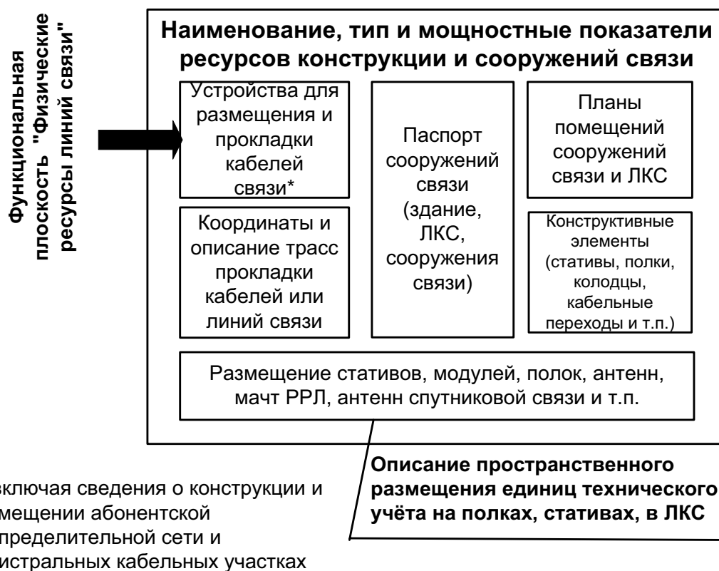
Рисунок 4.10 – Компоненты учёта «Ресурсы конструкции и сооружений связи»
